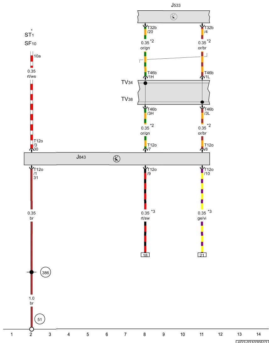
车辆定位系统接口控制单元, 舒适/便捷系统 CAN 总线 (High) 导线分线器
